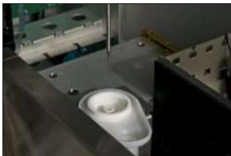
Estação de Lavagem de Sonda Única
