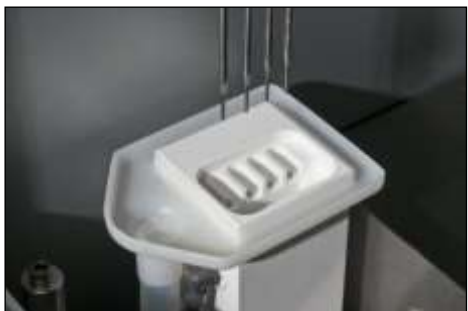
Estação de Lavagem de Quatro Sondas
