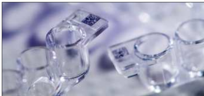
Código de barras bidimensional localizado no fundo da lingueta da tira de micropoços
