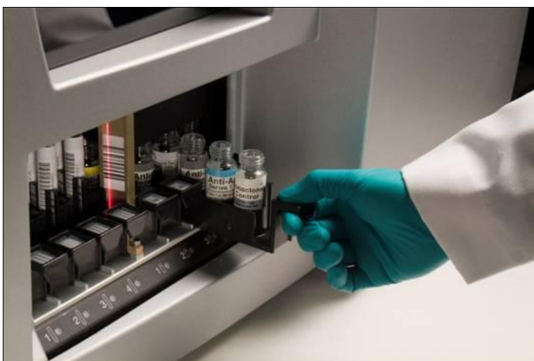
Operador a carregar reagentes na área de carregamento de reagentes
