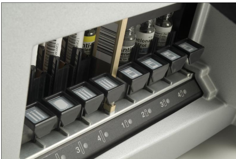
Módulos de área de carregamento de amostras e de reagentes (o suporte na posição 2 de amostra é o suporte de dador: repare no ícone do saco)
