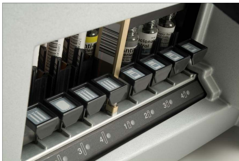
Áreas de carregamento de amostras e reagentes
