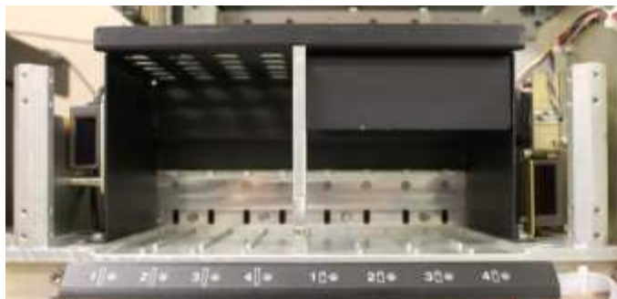
Imagem das áreas de carregamento de amostras e reagentes com espelhos
