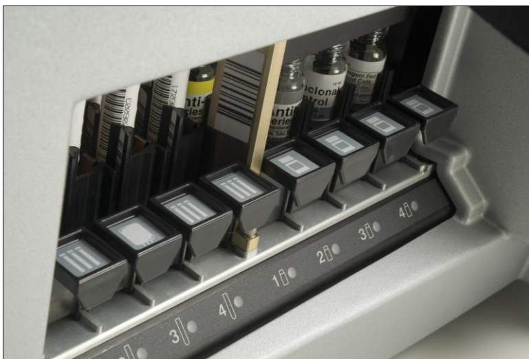
Módulos de área de carregamento de reagentes e de amostras (os suportes nas posições de reagente 1-4 são suportes de reagente: repare no ícone do frasco)
