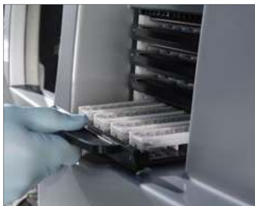
Ranuras de posição da incubadora ambiente
