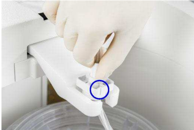
Fig. 34 Instalação do adaptador de centrífuga.
