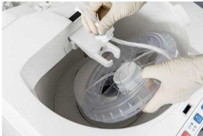
Fig. 33 Colocação da câmara de lavagem
