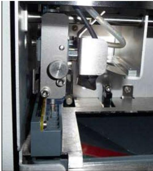
O sistema de transporte desliza as placas nos suportes de placas para dentro do lavador. Dois ímãs na parte de trás do lavador garantem que as placas estão posicionadas de forma correta e segura.
