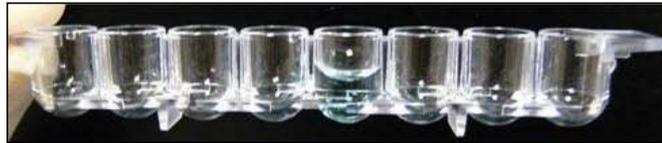
Excesso de líquido no poço de teste
