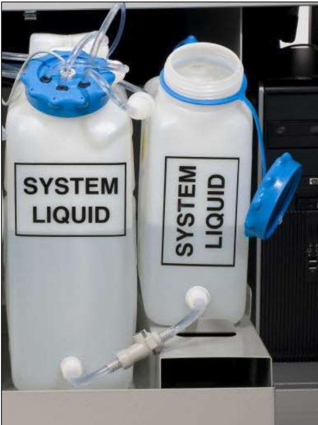
Recipiente de reabastecimento de 10 litros com tampa grande removida pronto para adição do Líquido do Sistema Galileo
