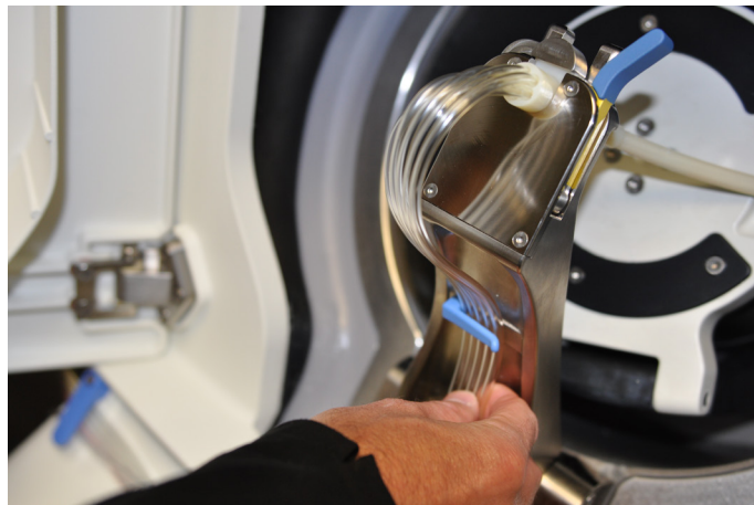
4.22 Linhas dos tubos da centrífuga na guia dos tubos ômega zero
