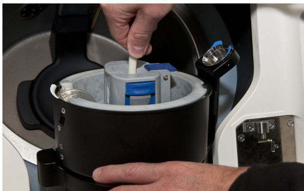
4.18 Suporte da junta do umbilicus corretamente instalado
