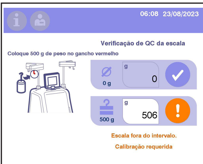
6.3 Tela Verificação de balança com falha
