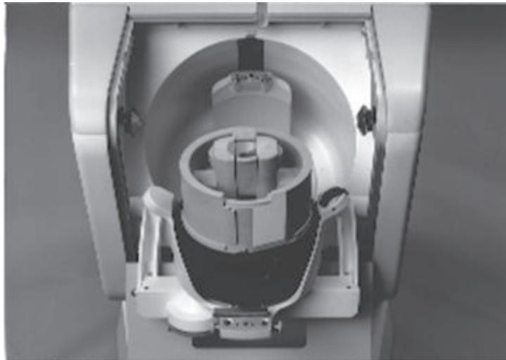
9. Localize a câmara de separação e posicione-a sobre a fita refletora do carretel.
