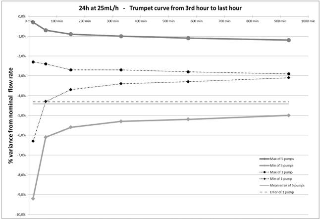
Trompetenkurven für Beobachtungsfenster von 15, 60, 150, 330, 570, 930 Minuten (25 ml/h über Überleitsystem-Austauschintervall 24 h)
