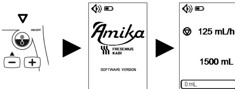
**Abbildung 3:** Selbsttest der Ernährungspumpe
