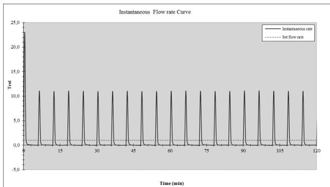
Start- und sofortige Förderrate (1 ml/h, über 2 Stunden des Testzeitraums)
