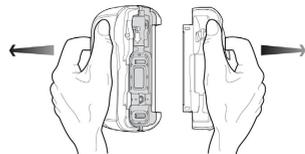
**HINWEIS:** Die Pumpentür darf in Flüssigkeiten getaucht werden. Die Pumpentür separat unter fließendem Wasser reinigen.
