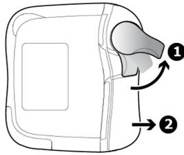
2. Die Schlauchklemme entsprechend der Pfeilmarkierung mit dem Klemmhebel in Flussrichtung in die Vorrichtung einlegen. **1**. Schlauchklemme eindrücken, bis sie hörbar einrastet. **2**.
