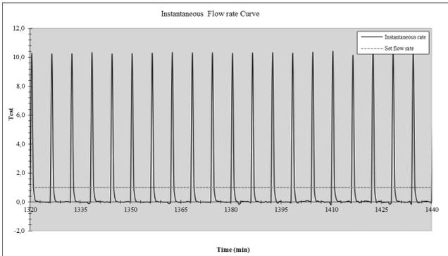
Sofortige Förderrate (1 ml/h über die letzten 2 Stunden unter Berücksichtigung des Austauschs des enteralen Überleitgerätes von 24 Stunden)
