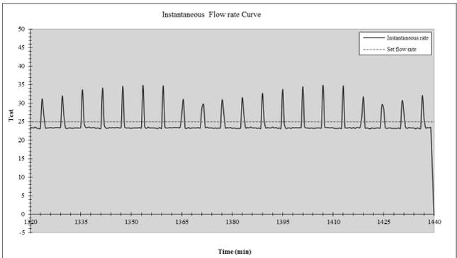
Sofortige Förderrate (25 ml/h über die letzten 2 Stunden des Überleitsystem-Austauschintervalls 24 h)
