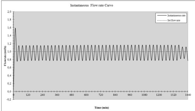
Sofortige Förderrate (1 ml/h, unter Berücksichtigung des Austauschintervall des enteralen Überleitgerätes von 24 Stunden)
