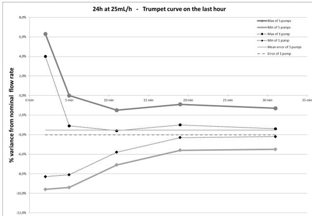
Trompetenkurven für Beobachtungsfenster von 2, 5, 11, 19, 31 Minuten (25 ml/h über die letzte Stunde des Überleitsystem-Austauschintervalls 24 h)
