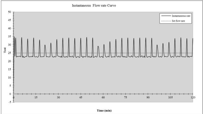
Start und sofortige zwischenzeitliche Förderrate (25 ml/h, über die ersten 2 Stunden des Testzeitraums)
