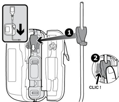
3. Den Schlauch über den Fördermechanismus führen und in der unteren Schlauchführung spannungsfrei fixieren. Auf korrekte Schlauchführung achten!
