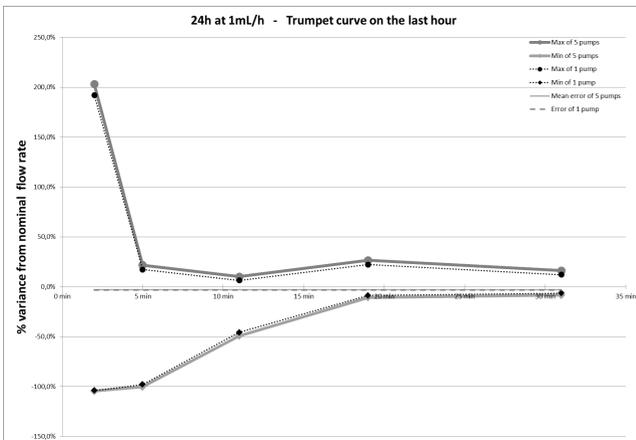
Trompetenkurven für Beobachtungszeit von 2, 5, 11, 19 und 31 Minuten (1 ml/h letzte Stunde unter Berücksichtigung des Austauschs des enteralen Überleitgerätes von 24 Stunden)
