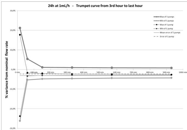
Trompetenkurven für Beobachtungszeit von 15, 60, 150, 330, 570, 930 Minuten (1 ml/h, unter Berücksichtigung des Austauschintervalls des enteralen Überleitgerätes von 24 Stunden)
