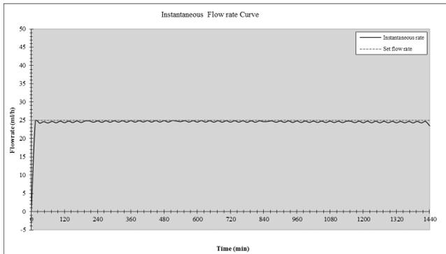
Sofortige Förderrate (25 ml/h, über Überleitsystem-Austauschintervall 24 h)
